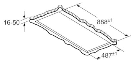
No montar el aparato directamente sobre tablas de yeso o materiales ligeros similares del falso techo. Se requiere una estructura inferior apta y que esté bien fijada al techo de hormigón.
