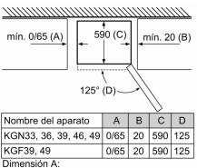
en modelos con tirador vertical integrado, se requiere una distancia mínima de 65 mm para una apertura sencilla.
