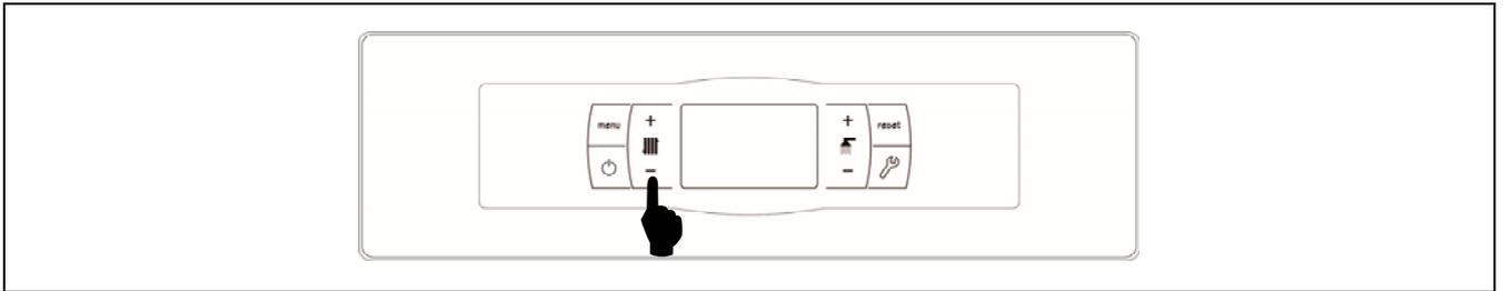
La selección de la temperatura deseada de funcionamiento de la caldera se realiza mediante el selector táctil indicado en la figura. Para seleccionar la temperatura deseada tocar en los símbolos "+" o "-" para incrementar o disminuir el valor de la temperatura, respectivamente. Una vez seleccionada la temperatura, en unos pocos segundos la pantalla regresará a la situación de reposo. El rango de consigna de temperatura de caldera seleccionable es de OFF, 65 - 80 °C.
