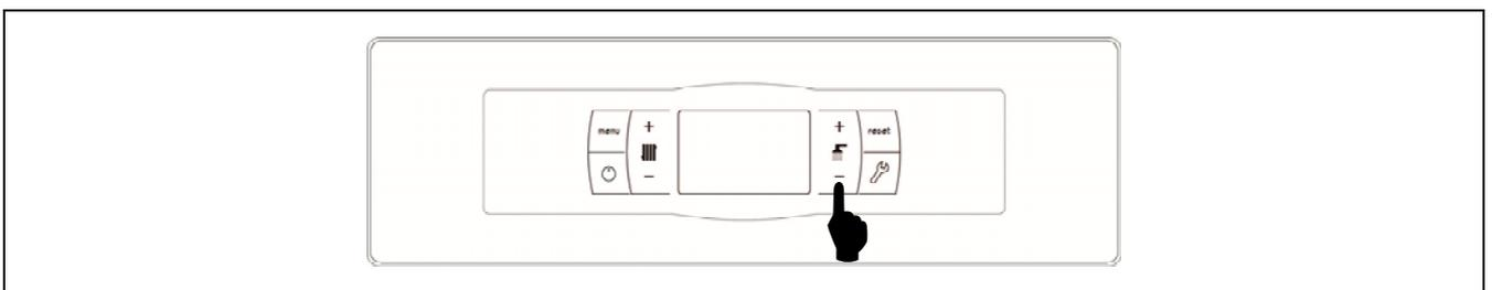
La selección de la consigna de temperatura de Agua Caliente Sanitaria deseado se realiza mediante el selector táctil indicado en la figura. Para seleccionar el modo de funcionamiento deseado tocar en los símbolos "+" o "-" para navegar entre los diferentes modos. Una vez seleccionado el modo, en unos pocos segundos la pantalla regresará a la situación de reposo. Se podrá seleccionar entre tres consignas de ACS:
