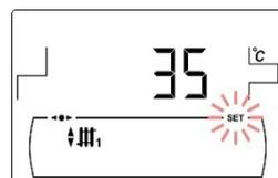
Consigna de temperatura de ida del circuito mezclado nº 1 seleccionada mediante el selector táctil correspondiente **(18)**.
