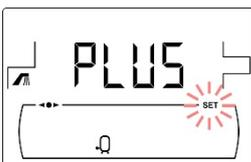
Consigna de A.C.S. seleccionada mediante el selector táctil correspondiente **(19)**
