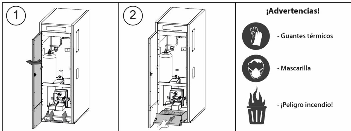
El usuario debe asegurarse regularmente del buen vaciado del cenicero, y comprobar en la pantalla de la caldera su nivel de llenado.
