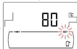
Consigna de temperatura de caldera, o de depósito de inercia (\*), seleccionada mediante el selector táctil correspondiente **(18)**.
